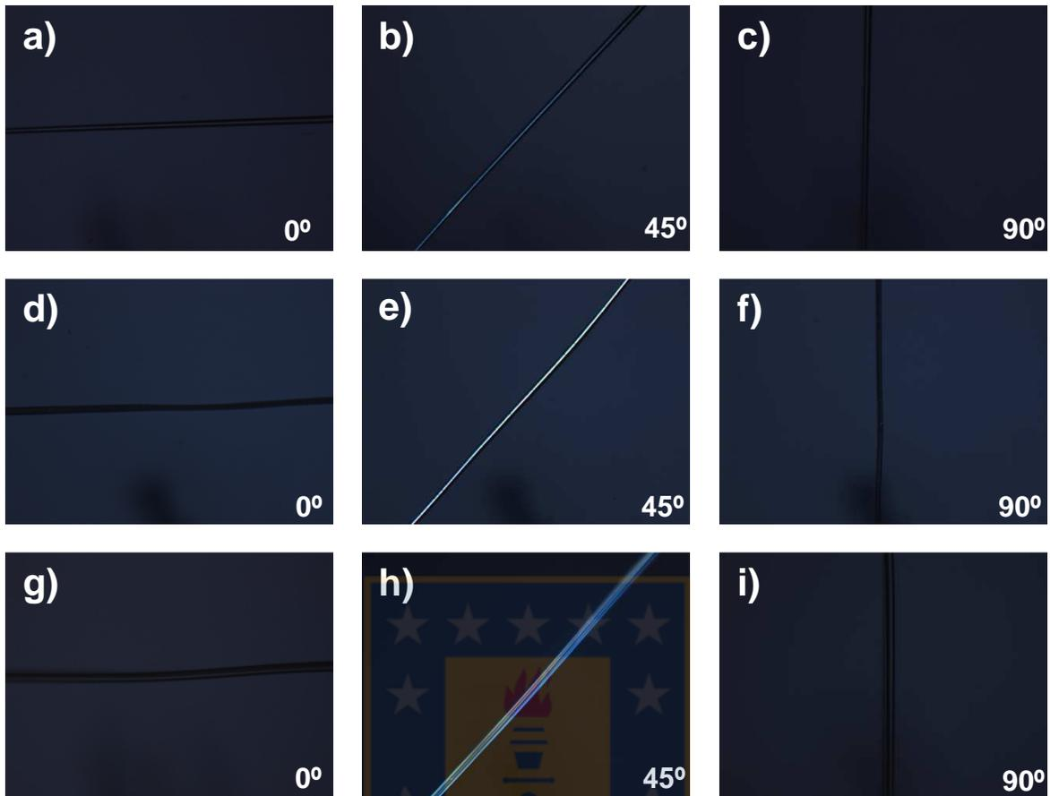
**Figura 31:** *Fibras obtenidas para los compuestos 11a-c observadas por MOP, bajo polarizadores cruzados: a),b) y c) fibra de 11a a 0°, 45° y 90° respectivamente; d),e) y f) fibra de 11b a 0°, 45° y 90° respectivamente; g),h) y i) fibra de 11c a 0°, 45° y 90° respectivamente.*
