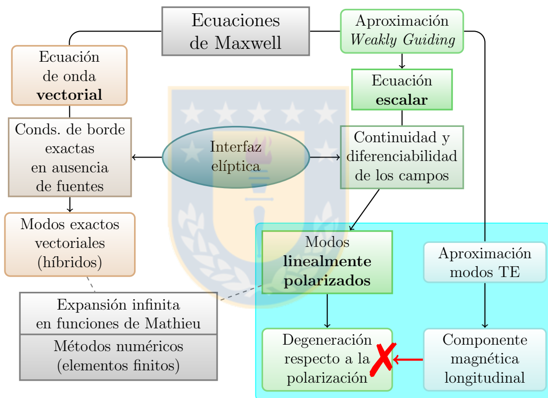
Figura 5.1: Teoría general del campo eléctrico en las guías de onda. El marco azul destaca la contribución del presente trabajo. Fuente: Elaboración propia.
