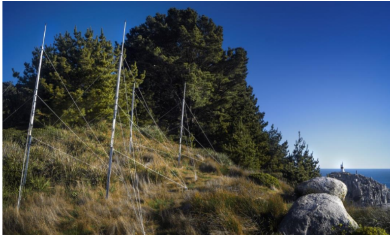
Figura 3.2: Antenas emisoras (a la izquierda) del radar en Faro Hualpén (al fondo). Fuente: http://chioos.cl/?project=radar-faro-hualpen .
