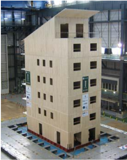
a) Ensayo estructura de siete pisos
