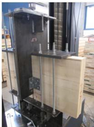
a) Ensayo con cargas cíclicas en conector de corte
