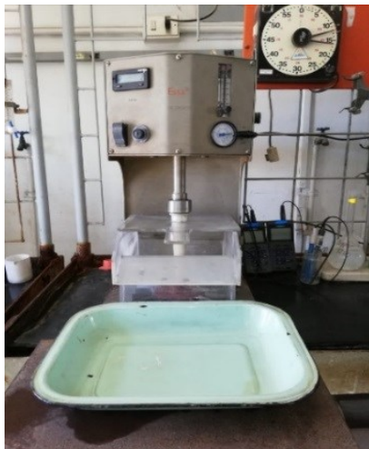
Figura 13. Montaje experimental de la flotación Rougher, provisto de celda de aireación forzada ESSA, timer, bandeja de recolección de concentrado e instrumentos de medición de potencial y pH.
