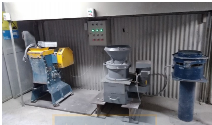
Figura 10. Montaje experimental de etapa de Chancado y Clasificación. De izquierda a derecha: Chancador de Mandíbula, Chancador de Cono y Harnero Vibratorio. (Fuente: Elaboración propia)
