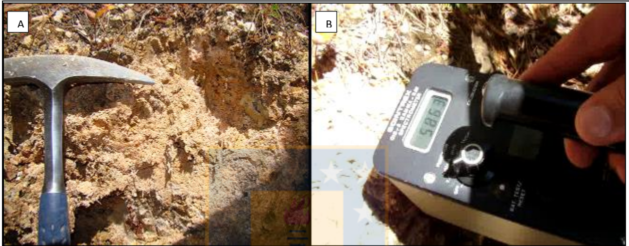
Fotografía 4.2 Medidas de radiación en muestra argilizada en Coyanmahuida A) Rocas fuertemente argilizadas. B) Conteo de energía gama mayor a 5000 cuentas por segundo.
