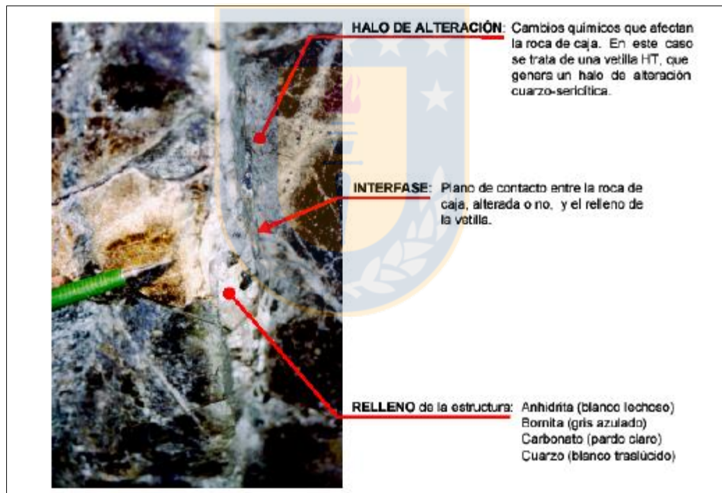
Figura 3.1: Ejemplo de una vetilla HT. Con varios minerales de relleno y un halo de alteración cuarzo-sericitica, además se muestra la interface o plano de contacto entre la roca caja y la vetilla. (Tomado de Karzulovic, 2001).
