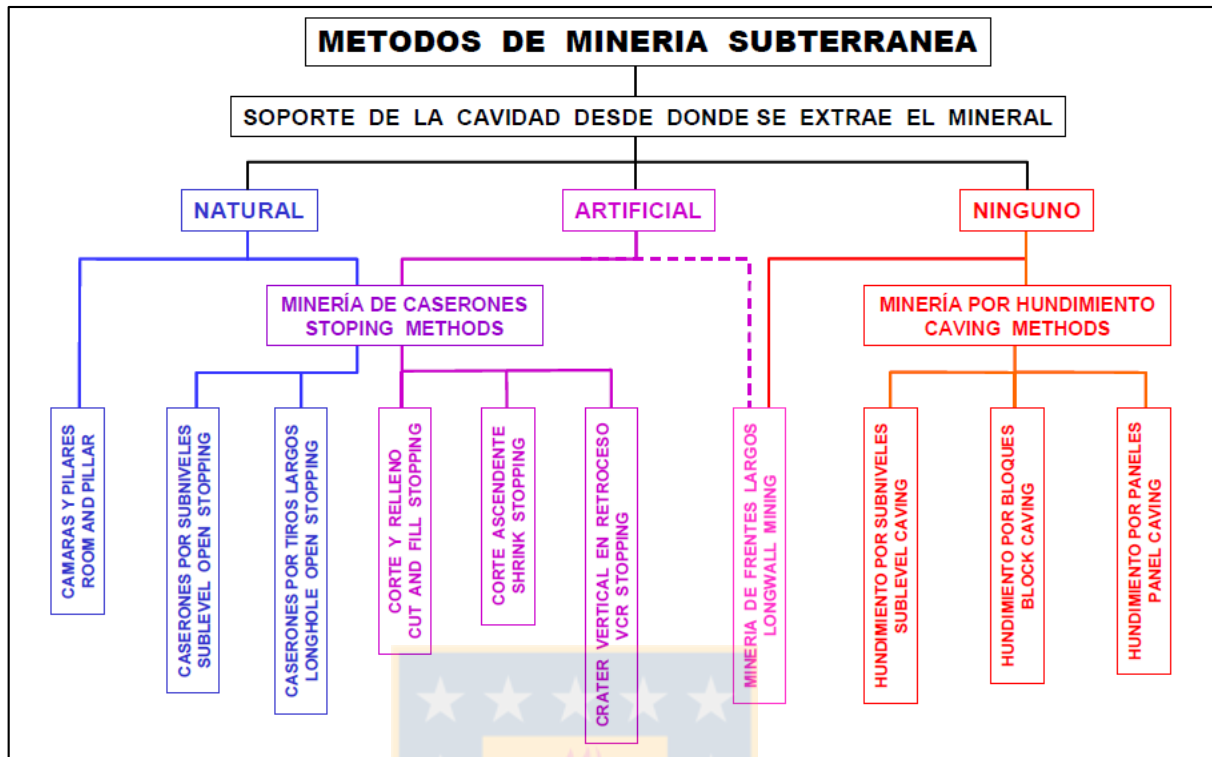
Figura 1.3. Clasificación de métodos de explotación (Brady y Brown, 1992).
