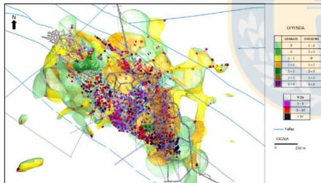
Figura 13. Modelo numérico combinado RBF de alteración Granate-Piroxeno con leyes de Zn >3% de muestras DDH y de mina en la Unidad Manto Principal.
