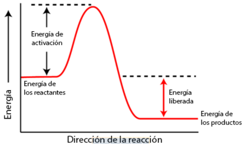
Figura 17. Diagrama de niveles de energía para una reacción exotérmica.
