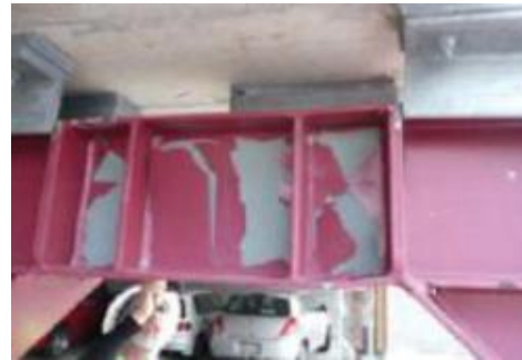
Figura 2.2: Rotura enlace (Oyarzún, 2012) Figura 2.3: Deformación inelástica enlace (Oyarzún, 2012)
