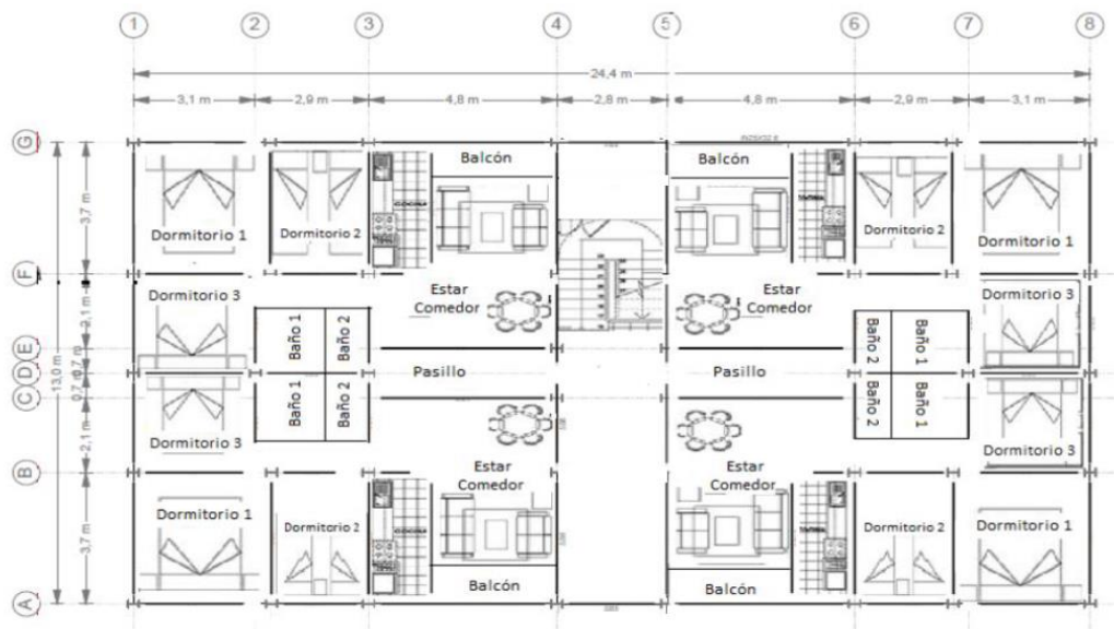
Figura 3.4: Planta arquetipos estructurales
