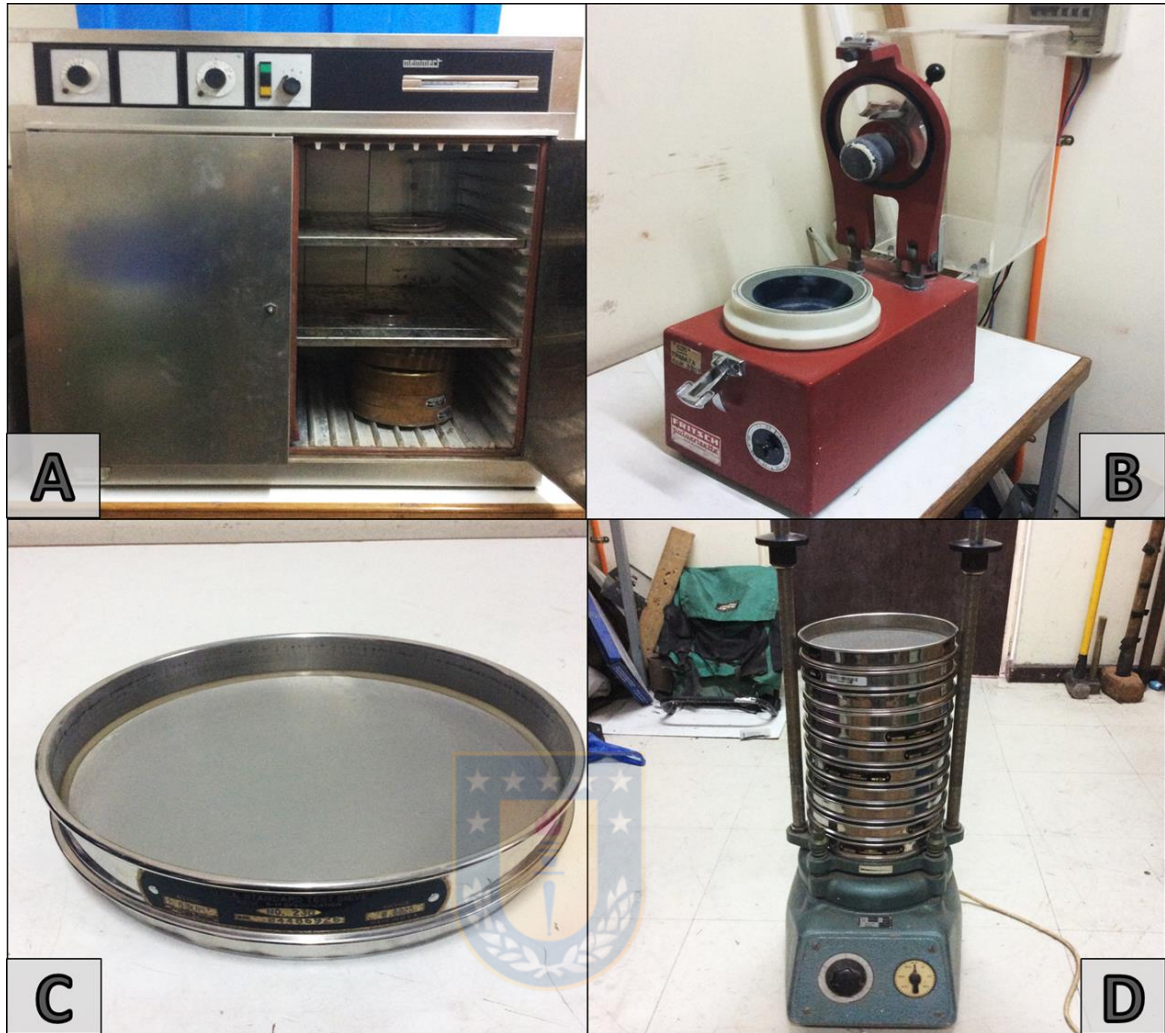
Figura 1.2. Herramientas utilizadas en el tratamiento de las muestras, previo al análisis de DRX y geoquímica. A) Horno industrial para secado de muestras. B) Mortero de ágata para chancado o conminución de las partículas. C) Criba o tamiz de malla #270 (0,053 mm). D) Pila de mallas utilizadas para la separación granulométrica de las partículas.
