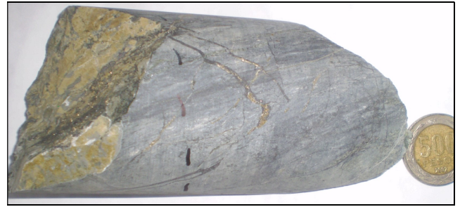
Fotografía 3: testigo de la zona denominada asimilación diorita-andesita, corresponde a un gneiss con vetillas de magnetita y centro pirita.
