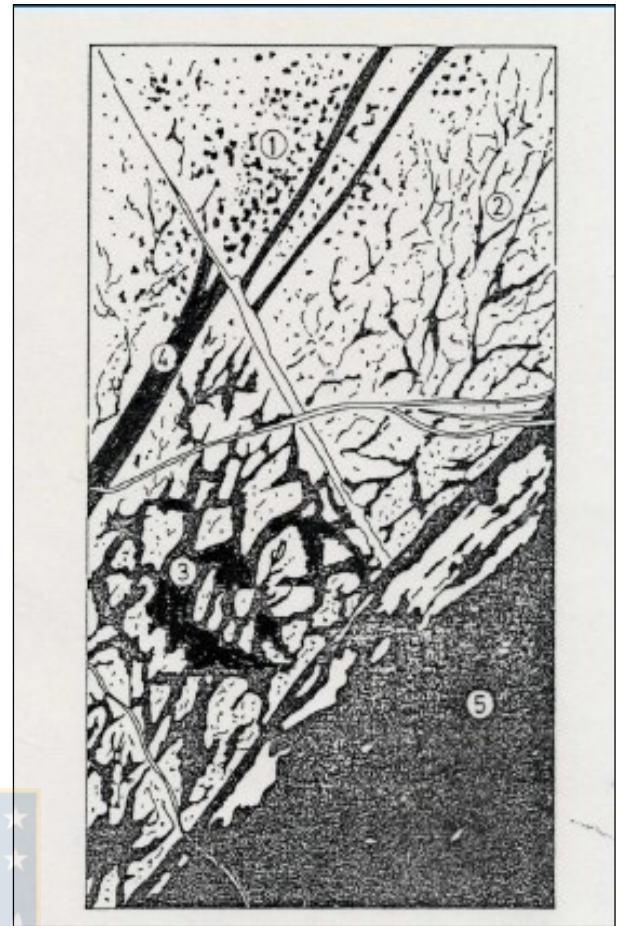
Figura 4: diagrama de clasificación de texturas de yacimientos de hierro, tomado de Espinoza (1979); 1) diseminado 2) vetillas polidireccionales 3) brechoso 4) vetas 5) macizo.
