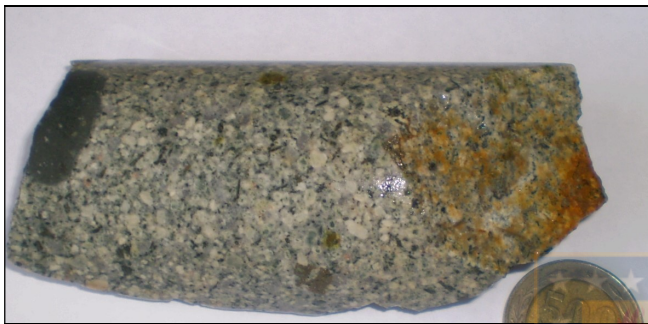
Fotografía 2: Pórfido Diorítico, tramo final sondaje Dom-0704.
