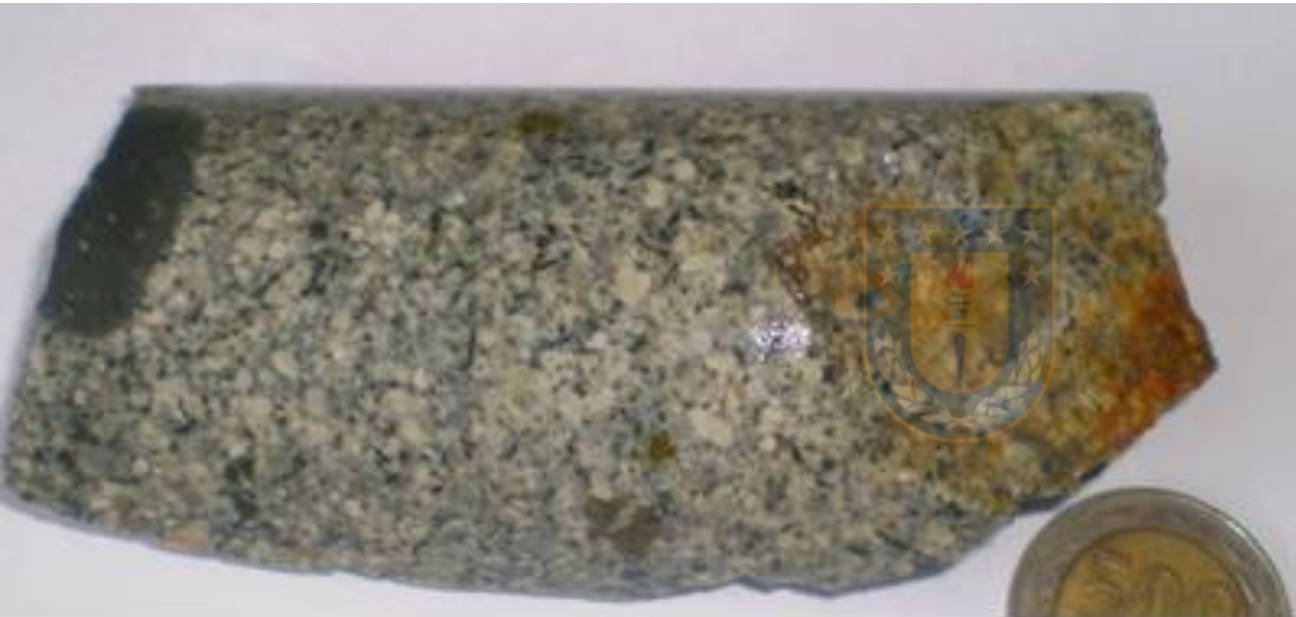
Fotografía 2: pórfido diorítico, tramo final del sondaje Dom-0704.
