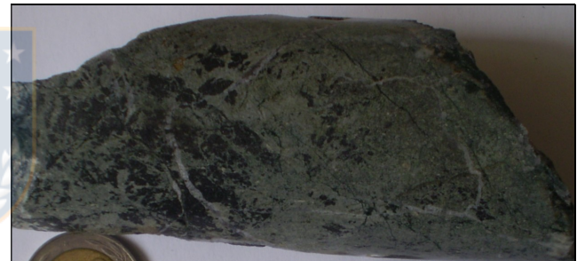
Fotografía 1: andesita con intensa alteración actinolítica, presenta magnetita diseminada y vetillas de calcita.
