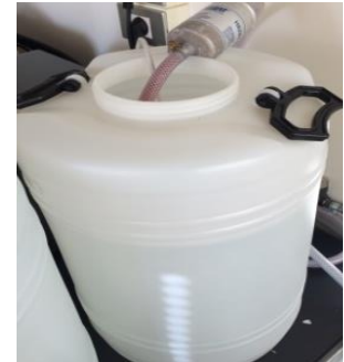
Fotografía 4.12 Contenedor de agua, capacidad 25 L y bomba.
