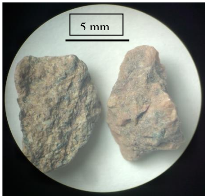
Fotografía 4.4 Fragmentos de rocas ígneas retenidos en malla #1/4". Lupa binocular 1,5x.
