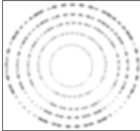
Figura 2.13 Patrón de interferencia dado por difracción de la luz: Disco de Airy. Modificado de Frias et al. (1988).
