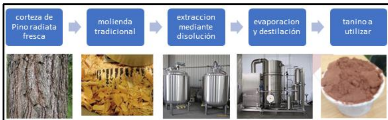
Figura 18. Proceso de extracción de polifenoles de la corteza de Pinus radiata . Fuente propia
