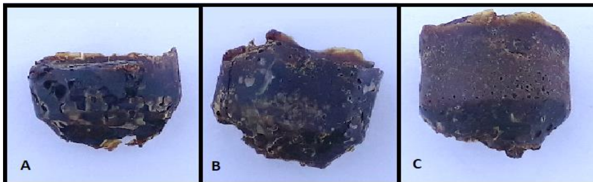
Figura 33. Síntesis de poliuretano a partir de taninos solubles y MDI. [A] Relación NCO/OH= 0.8, [B] Relación NCO/OH= 1.0 y [C] Relación NCO/OH= 1.25. Fuente propia
