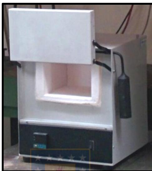
Figura 30. Mufla seleccionada para realizar el ensayo intumescente. Fuente propia
