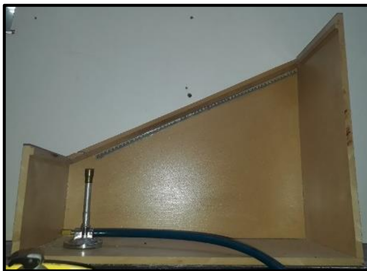
Figura 31. Túnel de flama. Fuente propia
