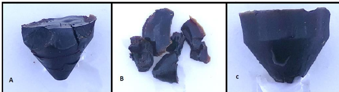
Figura 34. Síntesis de poliuretano a partir de taninos solubles y TDI. [A] Relación r_{\text{NCO/OH}}= 0.8 , [B] Relación r_{\text{NCO/OH}}= 1.0 y [C] Relación r_{\text{NCO/OH}}= 1.25 . fuente propia
