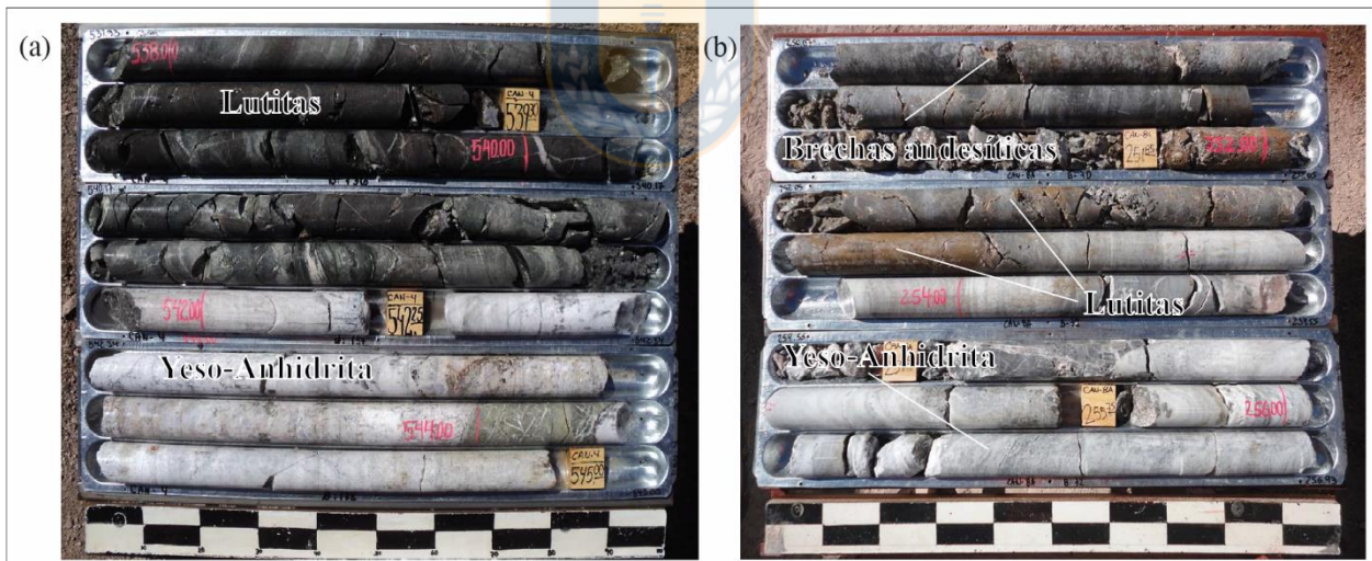
Fotografía 3.2 Relaciones de contacto de las rocas jurásicas. (a). Sondaje CAN-4, 542 m. Contacto gradual de intercalación de evaporitas y lutitas de edad Jurásica. (b). CAN-8A, 254 m. intercalación gradual entre yeso y lutitas bajo brechas andesíticas, de probable edad cretácicas.
