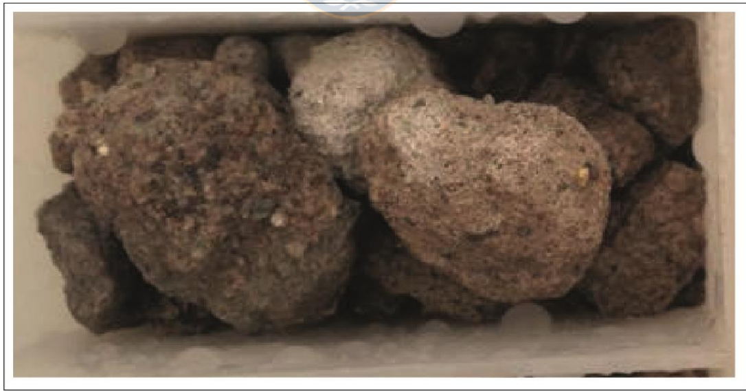
Fotografía 3.10 Muestra de cutting típica de la Unidad 13. El casillero de la caja de muestreo mide 5 x 2,5 cm. Pozo TYC-110/112-114. Andesita vesicular de piroxeno y hornblenda de color pardo amarillenta.
