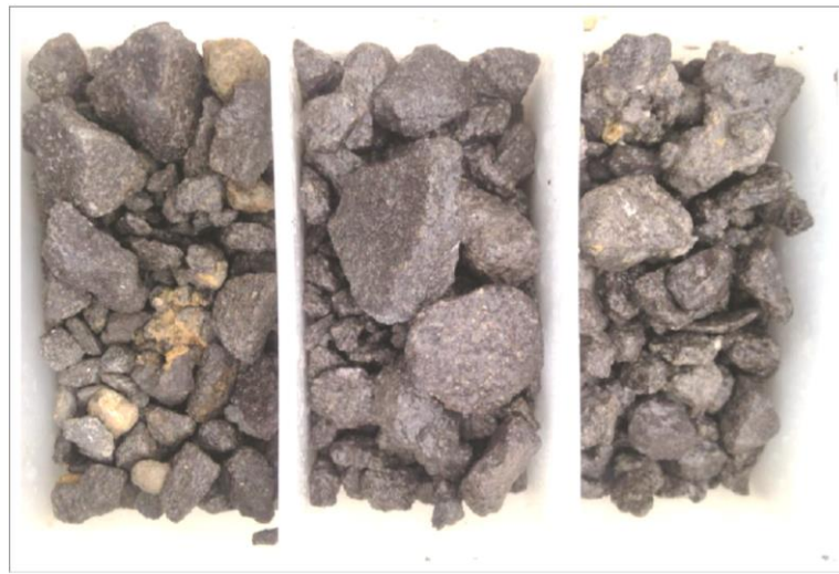
Fotografía 3.5 Fragmentos de Cutting pertenecientes a la Unidad 8. Sondaje CSE-14 88 a 94 m. Volcarenita parda rojiza, de textura fragmental rica en líticos oscuros y cristales alterados de plagioclasas.
