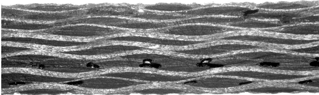
Figura 4.11: Imagen del microscopio con aumento x12 del tejido Bidireccional plano.
