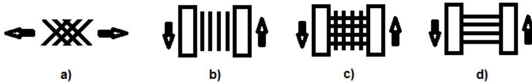
Figura 3.4: Esquema de ensayos: a) Tracción UD \pm 45^\circ Tr, Bi 45^\circ Tr y Tw 45^\circ Tr; b) Dos rieles UD 0^\circ 2R; c) Dos rieles UD 0^\circ/90^\circ 2R, Bi 2R y Tw 2R ; d) Dos rieles UD 90^\circ 2R.
