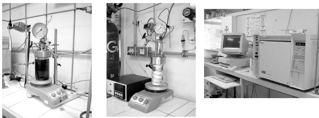
Figura 12. Equipos de reacción y cromatógrafo de gases empleados en el seguimiento de las reacciones.
