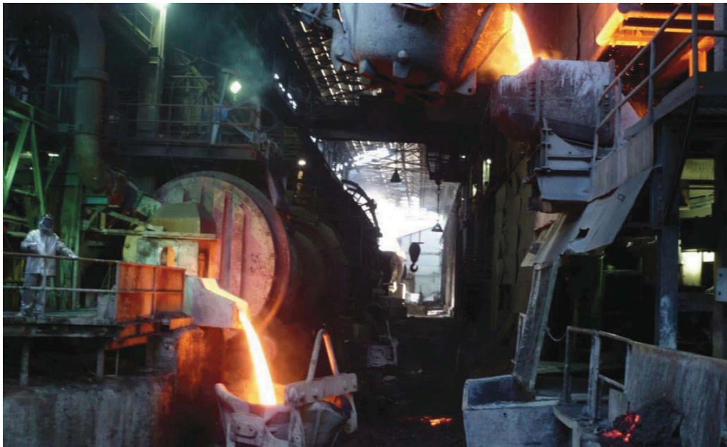
Fig. 3.2 Convertidor Teniente (izquierda) y descarga de escoria de fundición de cobre [3].
