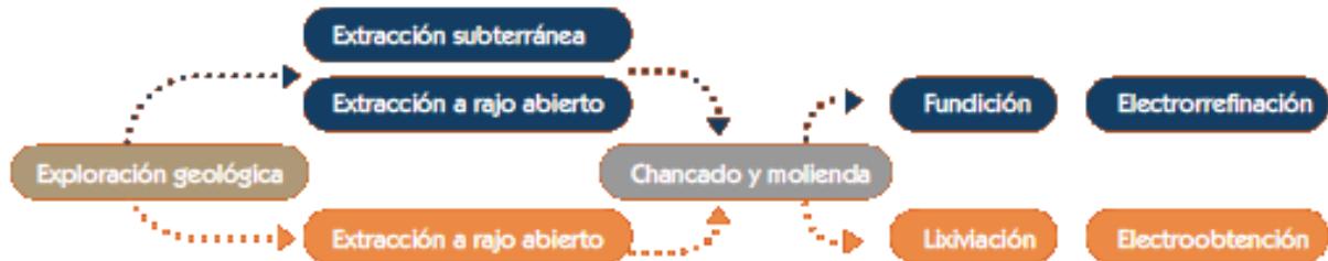
Fig. 3.1 Proceso de producción del cobre [3].
