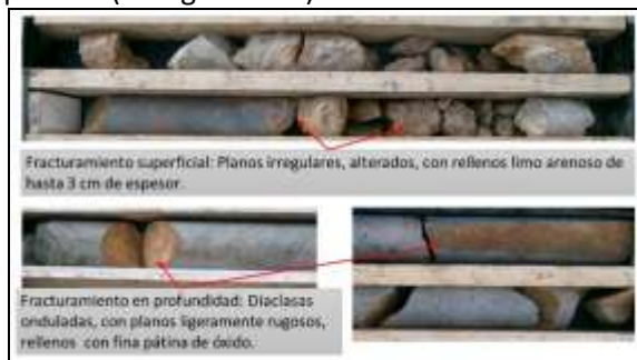
Fotografía 4.1 Fracturas superficiales y en profundidad observadas en granodiorita de anfíbol encontrada en el sondaje STG-3.
