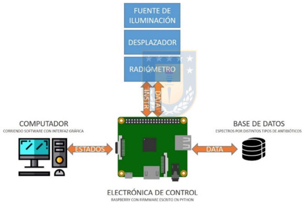
Figura A2.7: Diagrama de control Hardware Software y Firmware. Flujo de Datos del prototipo.
