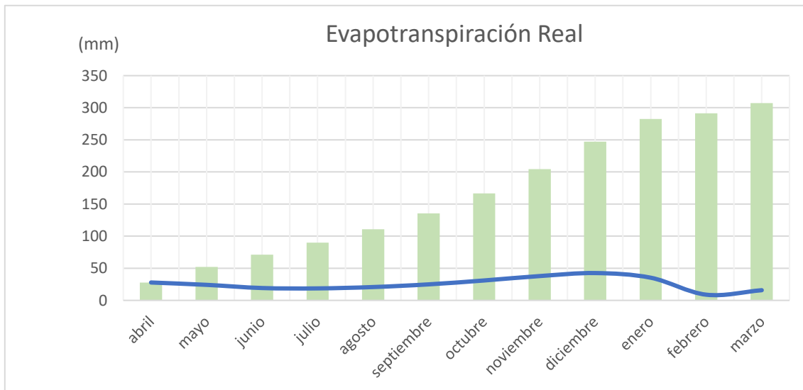
Figura 4.12: Evapotranspiración real. estimada con datos desde 1970 al 2000. En azul, curva con valores mensuales promediados de cada ráster; en verde, columna con cantidades acumuladas.
