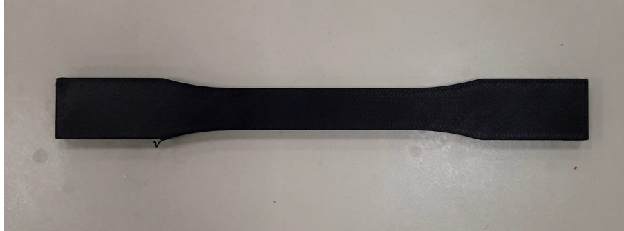
Figura 3.2: Probeta de caracterización fabricada en la impresora Markforged Mark Two.
