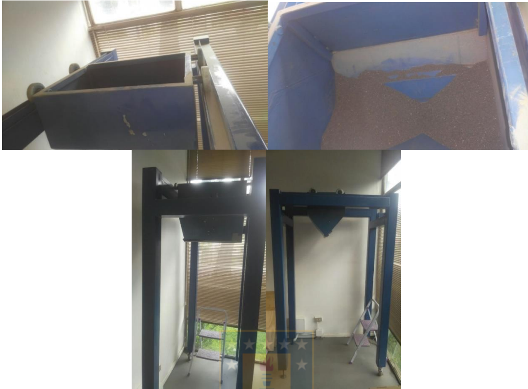
Figura 15. “ Pluviation method ” para obtener una densidad controlada.
