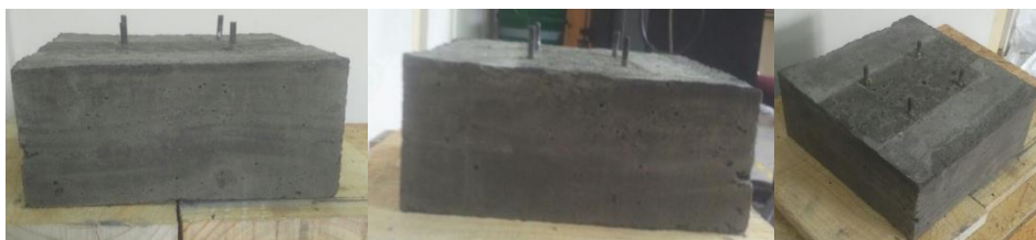
Figura 13. Fundación de concreto utilizada en el banco de ensayos.
