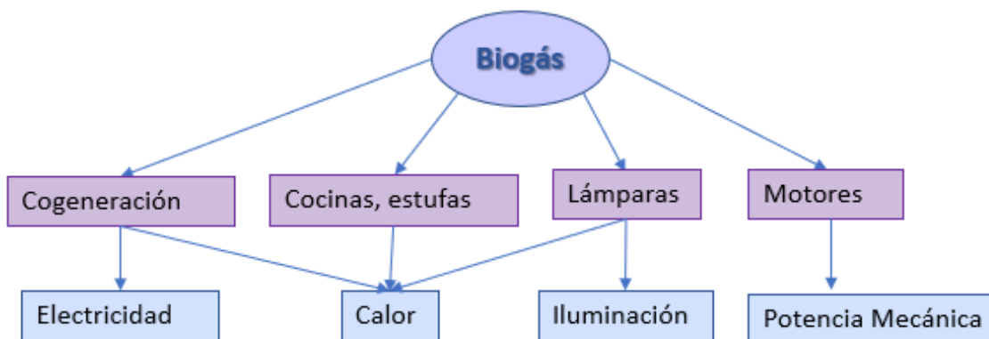
Figura 5: Usos del biogás.
