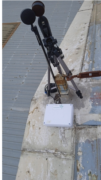
Figura 4.1.4: Medición de niveles para el proceso de homologación.
