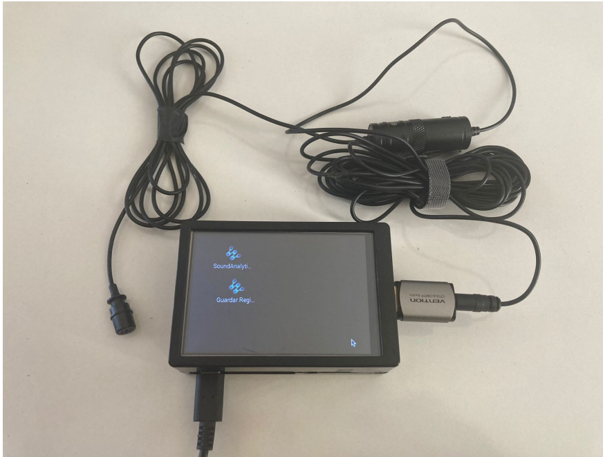
Figura 4.2.5: Sonómetro de mano.
