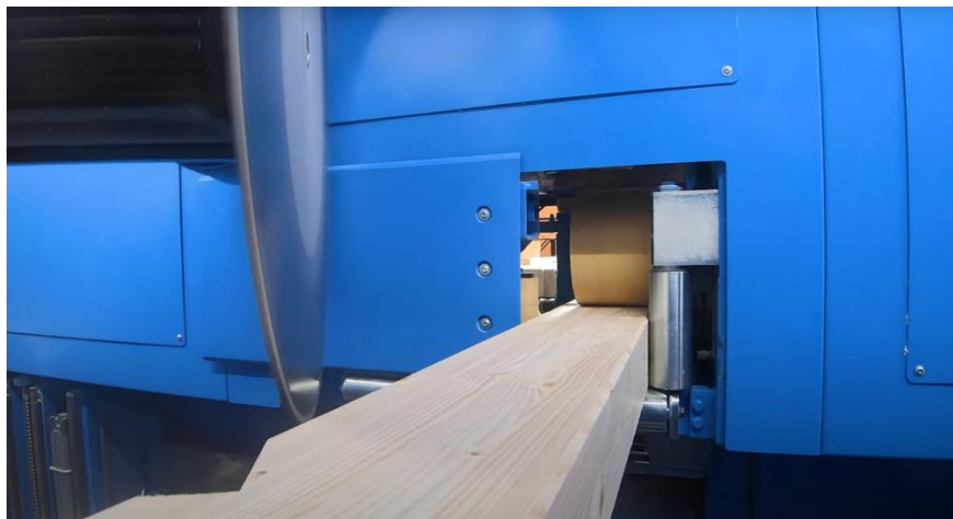
Figura 4.1: Ejemplo de método de avance de madera en maquinarias guías existentes (Fuente [5]).
