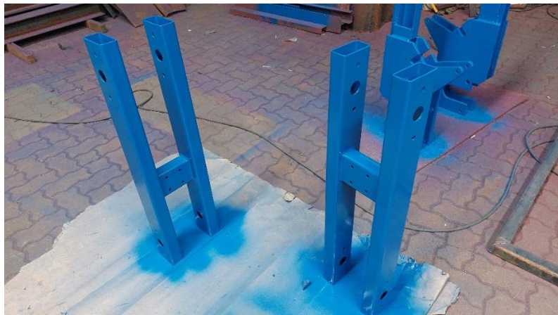
Figura 6.2: Construcción de brazos para ruedas de tracción.
