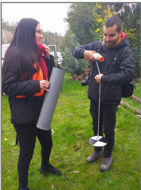
Fotografía 4.1: Instrumentos para medir la turbidez del agua. A la derecha aguascopeo casero, y a la izquierda disco Secchi.
