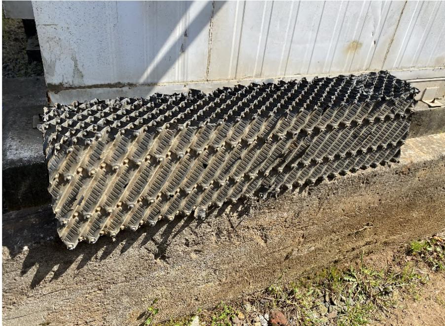
**Figura 35. Lamelas de la cámara de sedimentación del floccodecantador compacto.**
