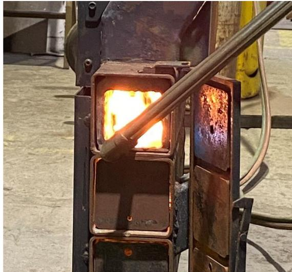
**Figura 5.7: Encendido del calefactor asistido por llama de gas butano-propano**
