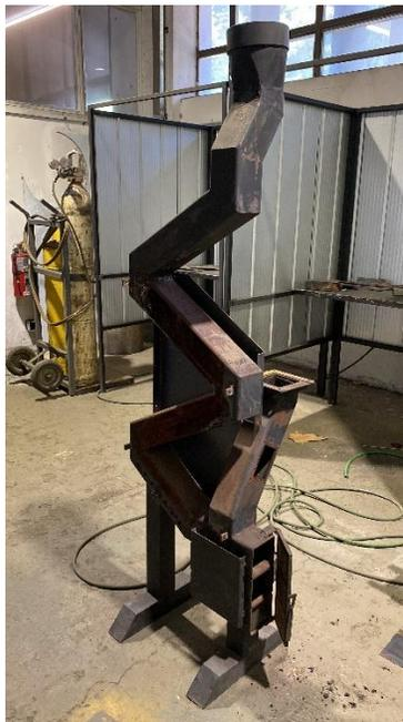
**Figura 4.3:** Elementos fijados por soldadura del calefactor a pellet no eléctrico
