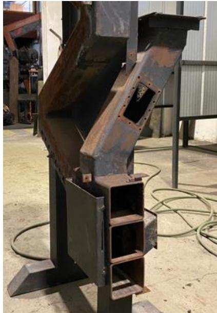
**Figura 4.2:** Montaje de ducto de alimentación de combustible y evacuación de gases a la cámara de combustión
