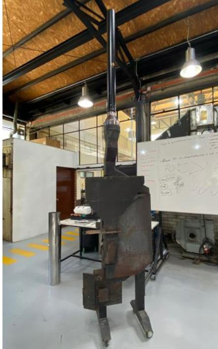
**Figura 6.14:** Calefactor con ducto de evacuación de gases de 80 milímetros
