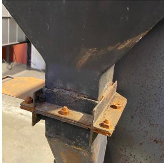
**Figura 4.4:** Unión apernada de la tolva de almacenamiento con el ducto de alimentación de combustible
