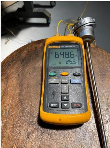
a) Termómetro digital Fluke 52 serie II, junto a termocupla tipo K
