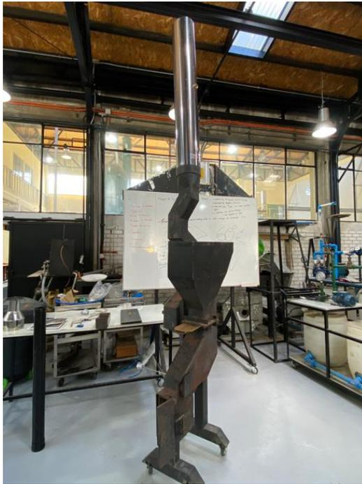
**Figura 6.3:** Calefactor con ducto de evacuación de gases de 6 pulgadas
