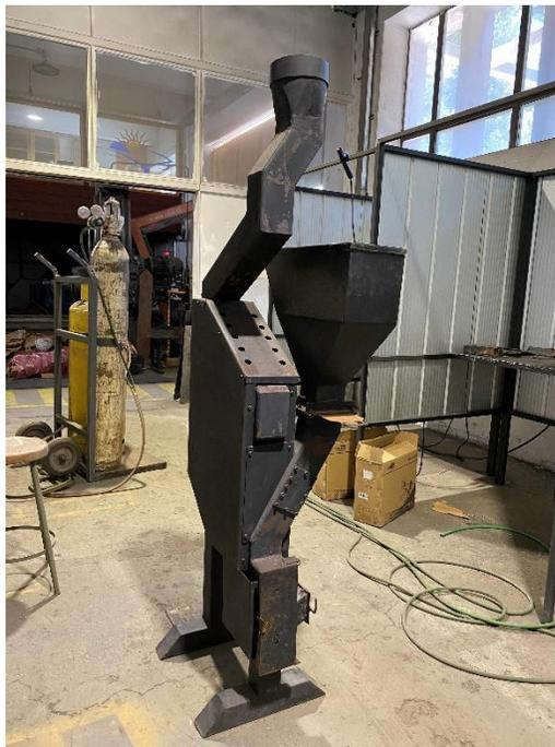
**Figura 4.5:** Modelo 2 de calefactor a pellet no eléctrico terminado
