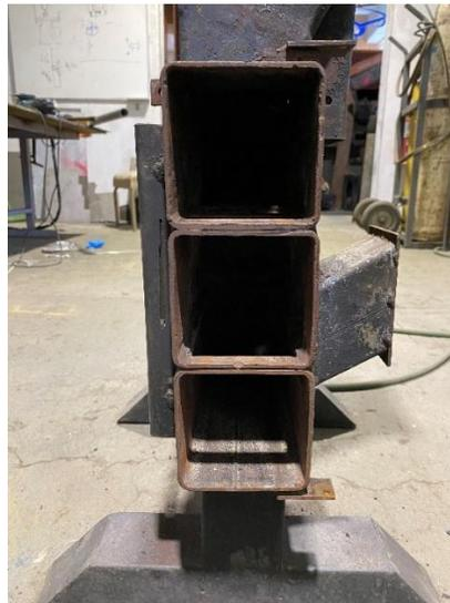
**Figura 4.1: Fabricación de la cámara de combustión y entrada de aire primaria**
