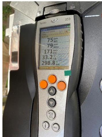
b) Analizador de gases de combustión Testo 350
