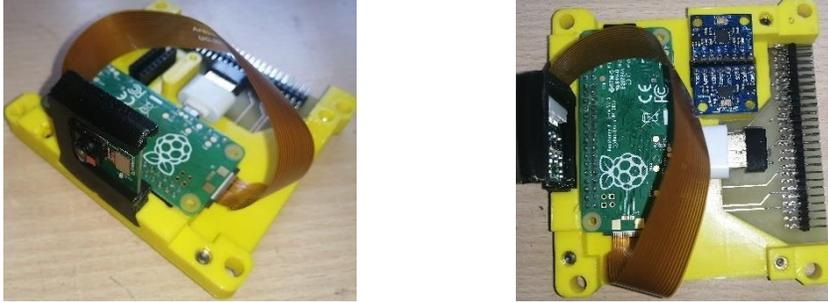
**Figura 3-28. Integración del subsistema C&DH.**
