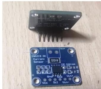
Figura 3-32. Sensor de corriente y voltaje INA219.
