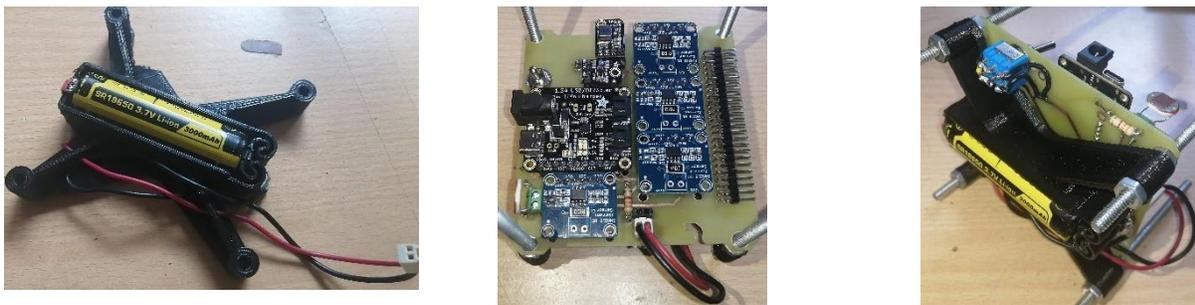
Figura 3-38. Integración del subsistema de potencia
