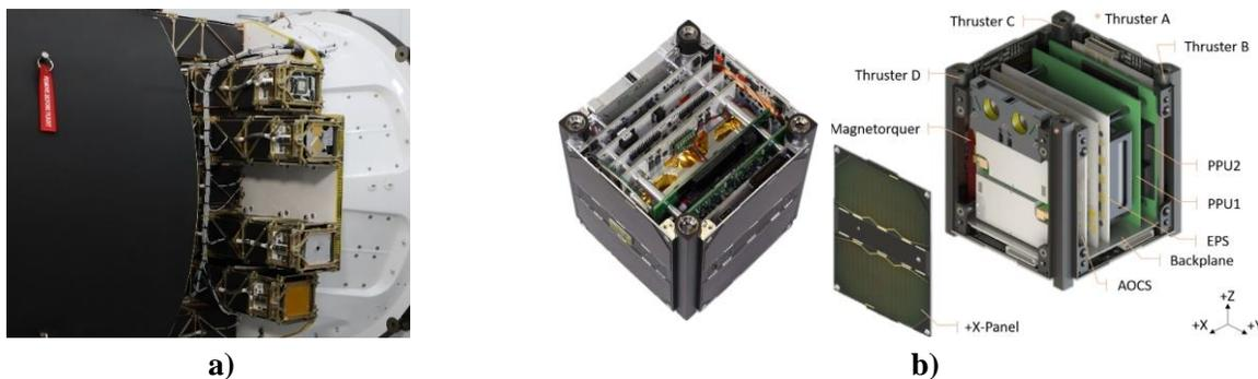
**Figura 1-5. a) POD siendo montados en un cohete Electron de Rocket Lab, corresponde a la misión ELaNA-19 de la NASA (Rocket Lab, 2022). b) UWE-4: CubeSat 1U desarrollado en la Universidad de Würzburg (Kramer & Schilling, 2021)**
