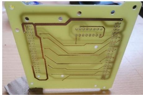
Figura 3-23. Placa de circuitos del C&DH fabricada.
