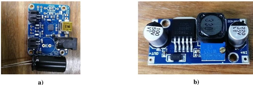
Figura 3-30. a) Módulo de carga solar ADA390, b) Regulador de voltaje XL6009
