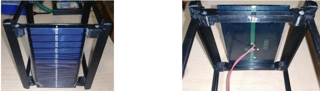
**Figura 3-13. Integración del panel solar a la estructura.**
