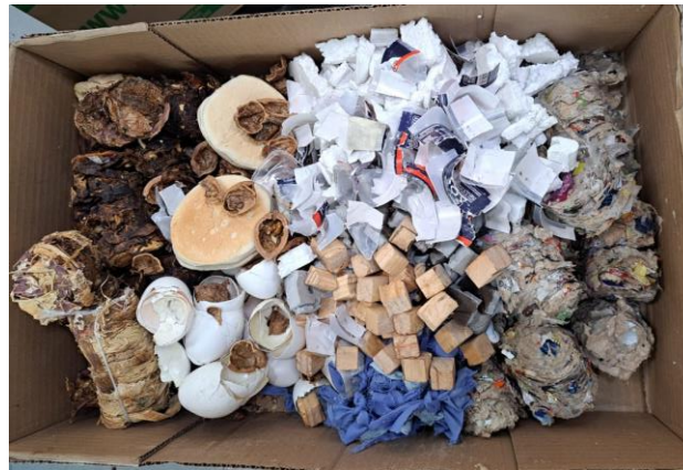
Figura 5.10: Carga de combustible a base de RSU para ensayos finales
