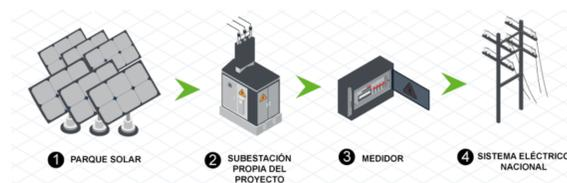
**Fig. 4.1:** Esquema de generación FV.
