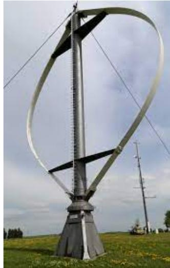
**Fig. 4.2:** Aerogenerador eje vertical tipo Darrieus.
