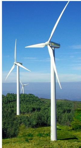
**Fig. 4.3:** Aerogenerador de eje horizontal.
