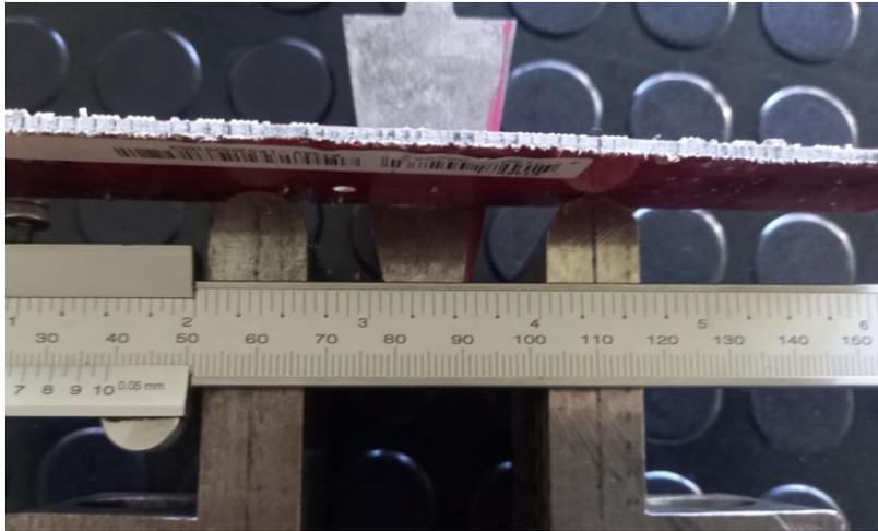
**Figura 2.6:** Distancia entre los dos soportes para el ensayo de flexión.
