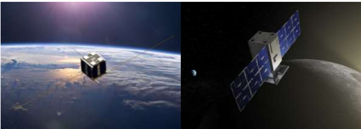
Figura 8: Ejemplos de configuración de paneles solares (Fuente: (Selina Haefeli, 2012)(izq) y (Alexandru Micu, 2022)(der))
