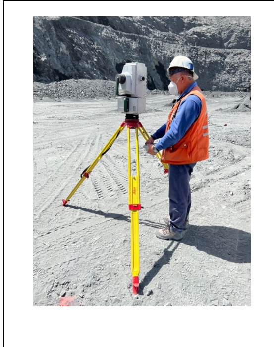
Figura 7.1.: Escáner láser Maptek montado en su trípode, mientras es configurado por asistente geólogo de la mina.
