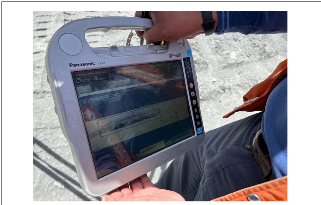
Figura 7.2.: Pantalla del escáner láser Maptek. La pantalla muestra la pared del banco mientras está siendo escaneada.
