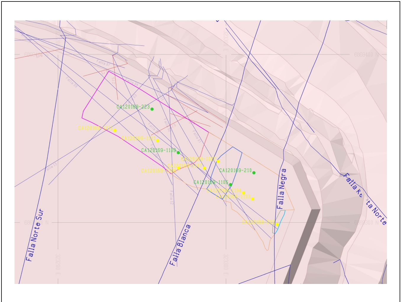
Figura 7.11: Vista en planta de malla CA120169 con información estructural. Traza de fallas principales en azul, fallas obtenidas por escáner en líneas azules delgadas y diaclasas en líneas rojas. El color de cada pozo indica su reactividad según ensayos.
