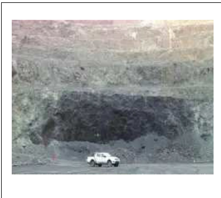
Figura 4.2: Dique de Fe W. Principal exponente de magnetita de alta ley en el yacimiento (58%-67% de Fe, textura Macizo). Vista hacia el NNE, nivel 270 Norte (Extraído de Munizaga & Lagos, 2015).
