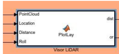
Fig. C.1. Bloque Matlab Function para el procesamiento de datos.
