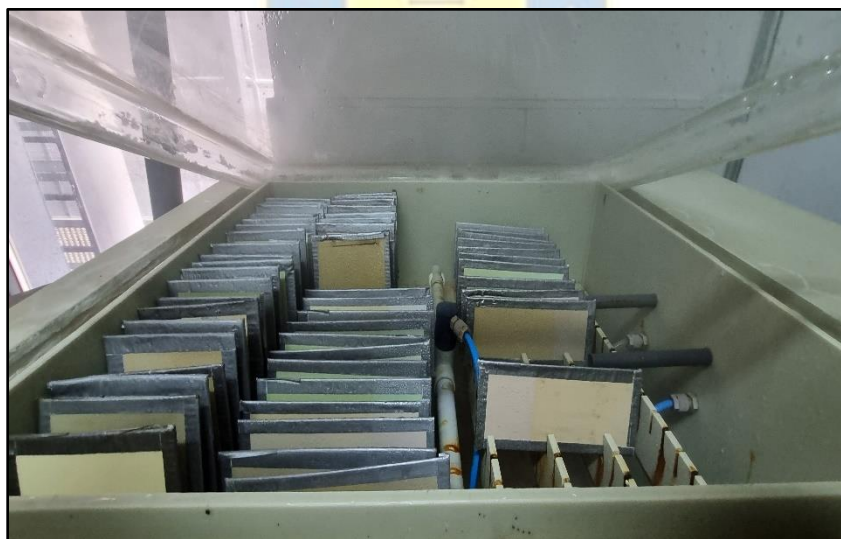
Figura 25. Probetas en ciclo de cámara de niebla salina. Fuente: elaboración propia.
