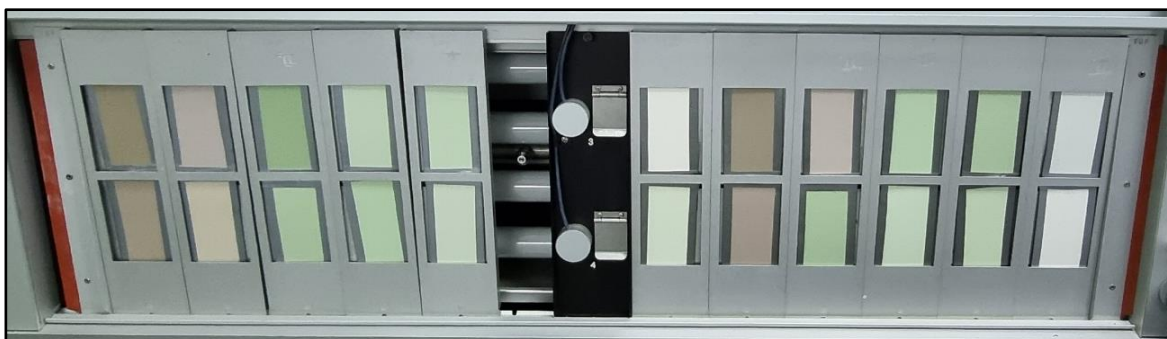
Figura 24. Colocación de probetas en cámara de intemperismo. Fuente: elaboración propia.
