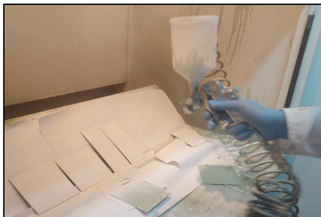
Figura 23. Aplicación de los recubrimientos sobre los sustratos metálicos. Fuente: elaboración propia.
