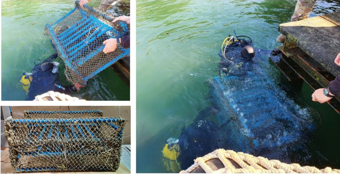
Figura 27. Estación de monitoreo para evaluación de recubrimientos antifouling.
