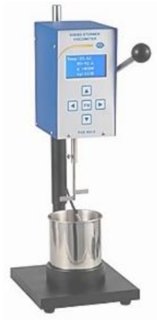
Figura 13. Viscosímetro de paleta Krebs.
