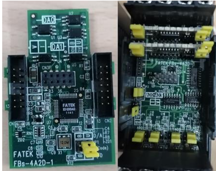
Fig. 4.2 Configuración Final de Jumpers para el Proyecto (Elaboración propia).
