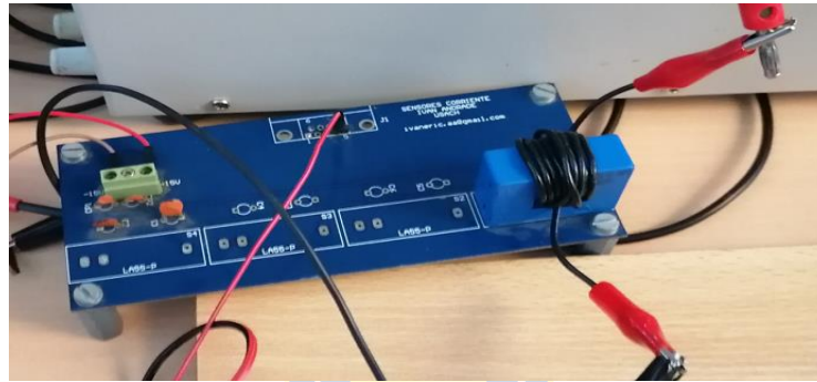
Fig. 2.12 Sensor de Corriente Instalado (Elaboración propia).
