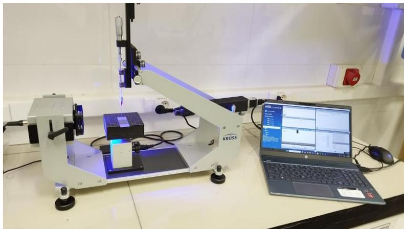
**Figura 4.2:** Montaje para medición de ángulo de contacto
