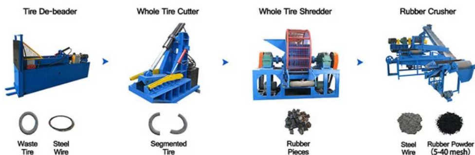
Figura 6. Proceso para la obtención de partículas de caucho a partir de NFU.
