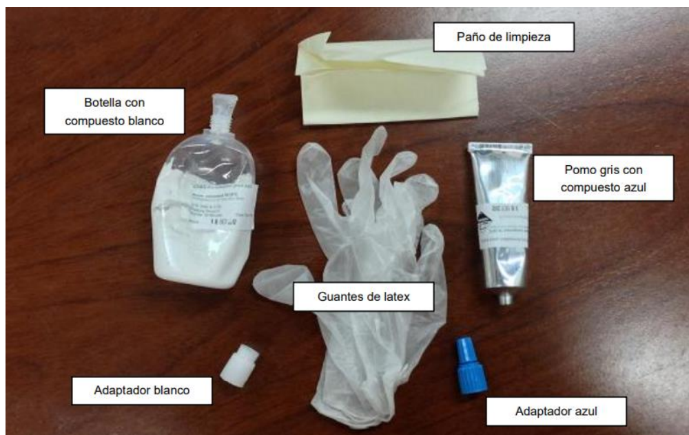
Figura 3.10: Componentes e insumos de la resina para instalación de celda HI [14].
