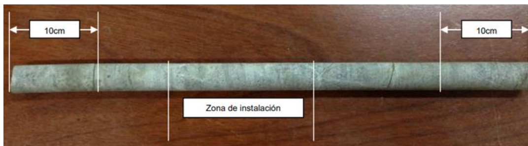
Figura 3.6: Zona de instalación celda HI [14].
