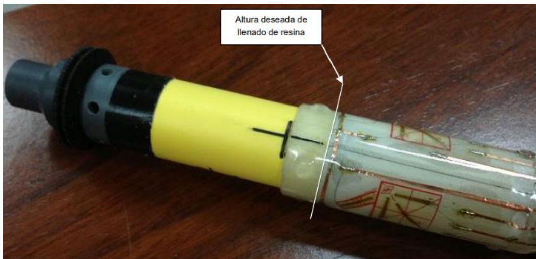
Figura 3.11: Altura correspondiente para el llenado de la celda HI con resina [14].
