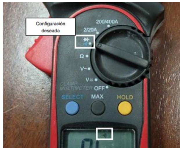
Figura 3.14: Configuración de multítester para medición de continuidad [14].
