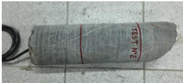
Figura 3.19: Marcaje en testigo de 15.24 [cm] en ubicación de celda HI [14].
