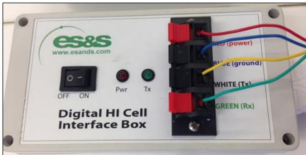
Figura 8.4: Conexión de cable de comunicación de celda HID con Interfaz [14].
