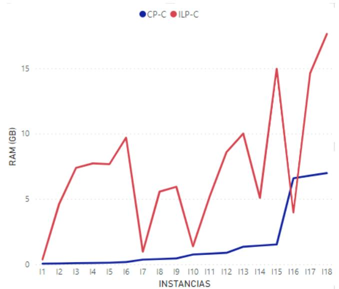
Figura 11: RAM (GB) utilizada en el experimento C – SPP-50.
