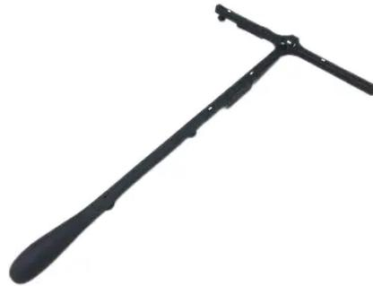
**Fig. 3.2:** Varilla con marcadores para calibración sistema Vicon [9]
