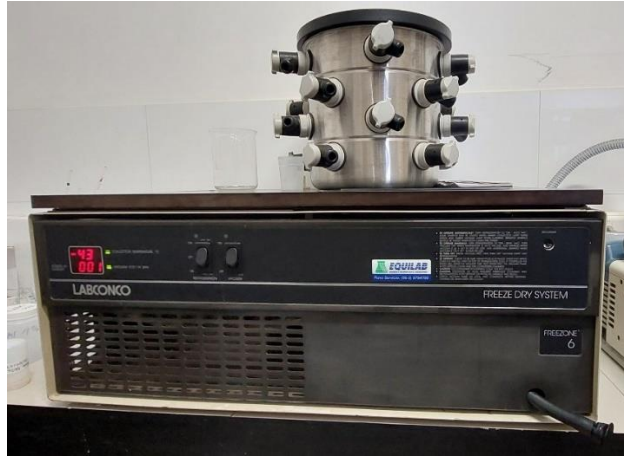
Fig. 9: “Freeze dry system” usado durante la liofilización operando a 0,01 Bar y a -43°C.
