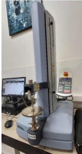
Fig. 10: Equipo de compresión Shimadzu EZ-SX utilizado durante la prueba de compresión.
