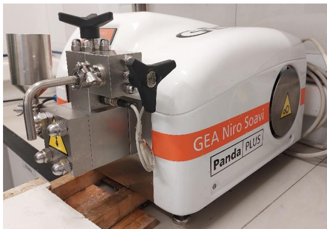
Fig. 5: PANDA GEA plus utilizado durante la homogeneización.
