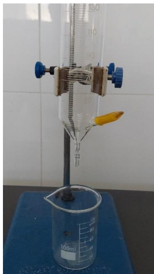
Fig. 7: Equipo utilizado para la formación de esferas de alginato.
