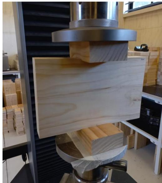
**Figura 3. 12: Implementación de ensayo según Esquema A cargado en el centro.**
