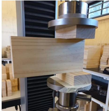
Figura 3. 7: Implementación de ensayo según Esquema A de Basta *et al* (2011).
