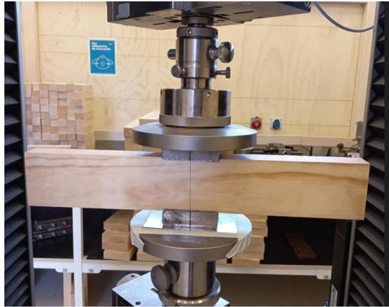
Figura 3. 5: Implementación de ensayo según NCh 3028-1.
