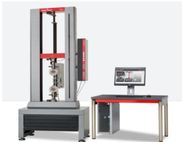
**Figura 3. 13: Máquina de ensayos universal ZwickRoell ProLine Z100.**
