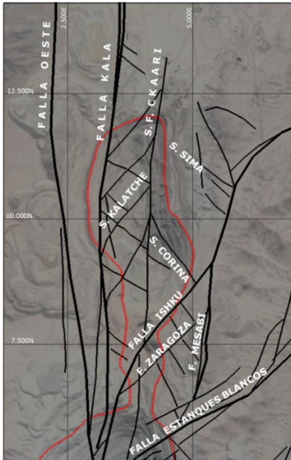
**Figura 3.1: Esquema de los principales sistemas y estructuras del norte de Chuquicamata y rajo Radomiro Tomic.** La línea punteada roja representa la topografía del pit final 2019 (Rojas, 2020)
