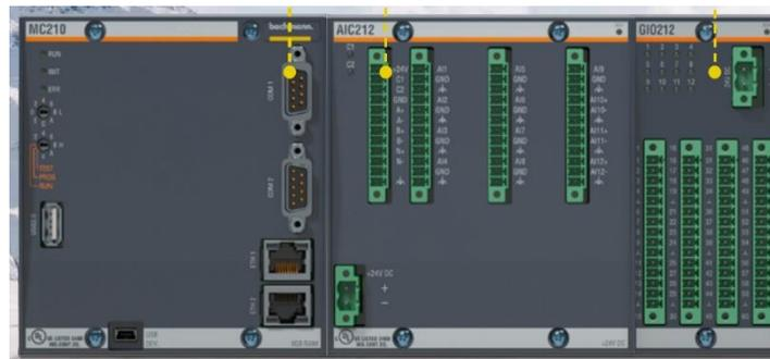
Figura 15: PLC utilizado para control de plantas eólicas [36].
