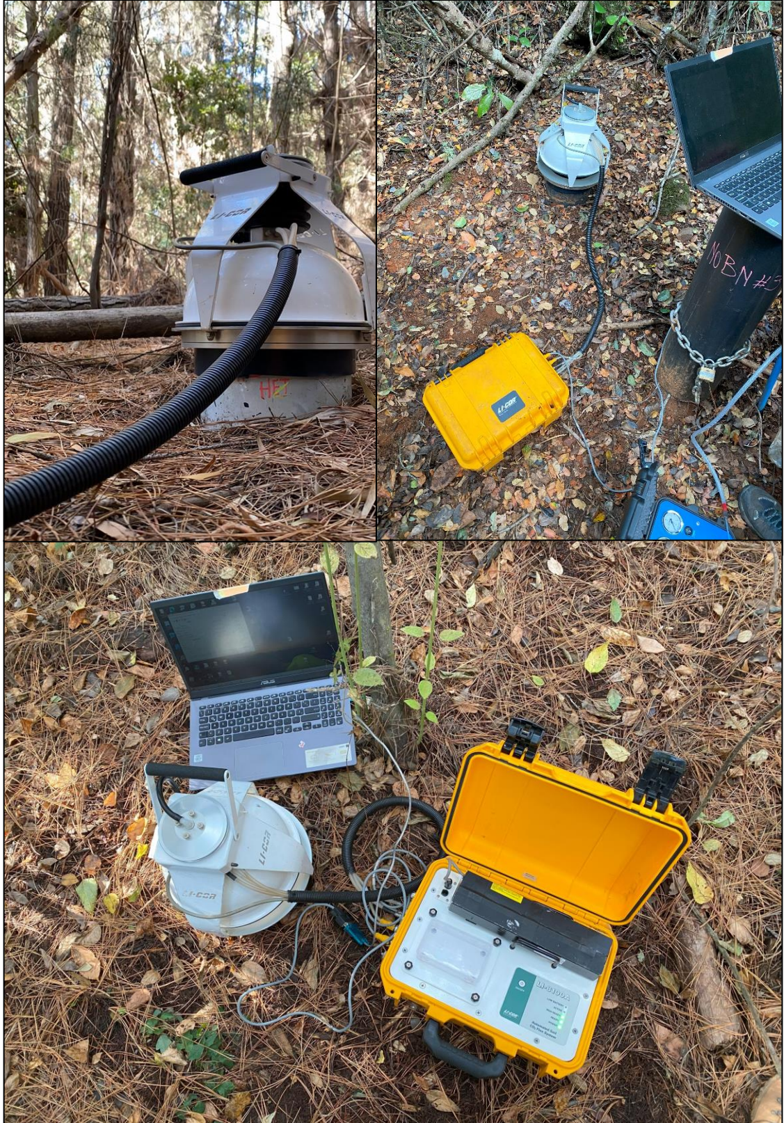
Figura 3.2. Dispositivo LI-COR 8100A durante el trabajo en terreno.
