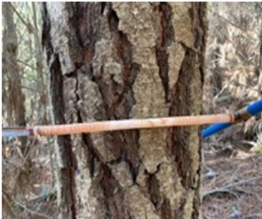
Figura 4. Extracción de tarugo de incremento al DAP de 12 mm de diámetro.
