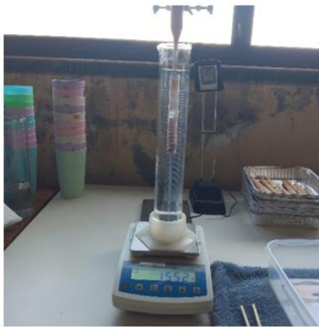
Figura 7. Procedimiento para la determinación del volumen en estado ( V_v ) de la madera, mediante el método de inmersión en agua según la norma Finlandesa SCAN-CM 43 (1989).
